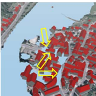
Bild 25: Oberirdischer Hochwasserzufluss zur Hauptstraße vor dem Rathaus
